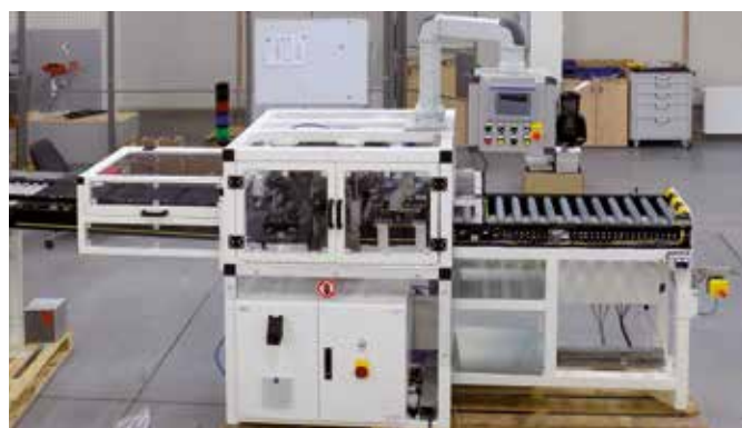
Stroj na precizní vyhodnocování OK/NOK kusů kombinací kamerového systému a mechanických dorazů
