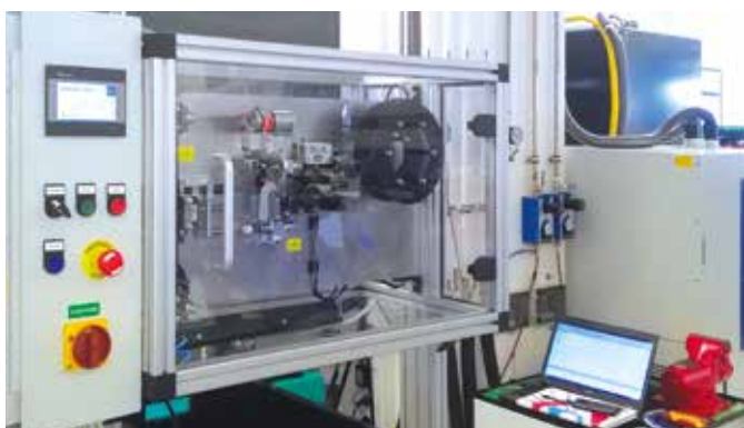
Stroj na řezání izolací pro laparoskopické jehly
